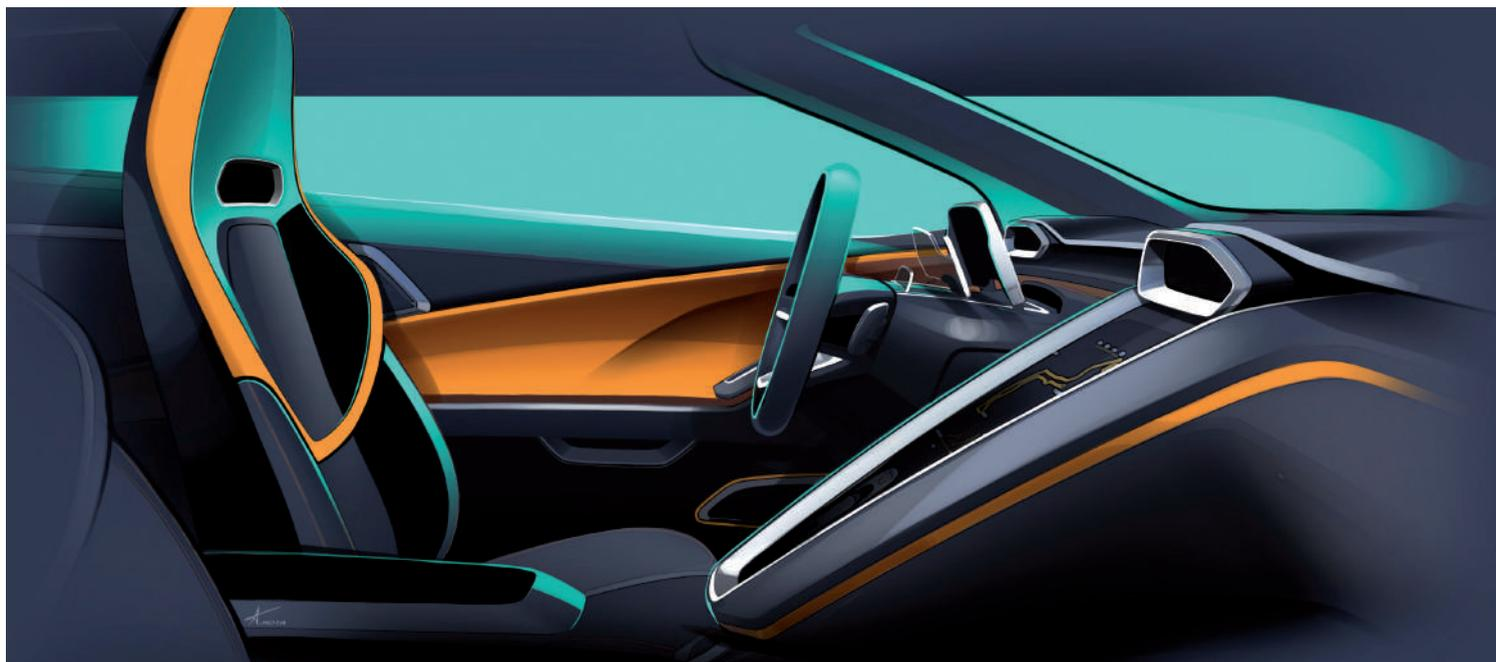
Il piccolo monitor alla sommità del volante di guida indica la marcia innestata, mentre il display Oled più grande posto di fronte al guidatore può scorrere avanti e indietro a seconda della modalità di guida. In "Drive", lo schermo di fronte al volante si avvicina al pilota; quando, invece, si porta il veicolo in modalità "Pista!", scorre all'indietro allontanandosi. Il monitor principale in posizione centrale fornisce le informazioni sulla navigazione.
