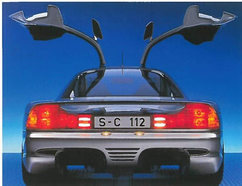
I movimenti dinamici della carrozzeria della C 112. Oltre le portiere ad ala di gabbiano, tradizionali per la Casa, lo spoiler posteriore che contribuisce al carico aerodinamico e alla frenatura nelle diverse posizioni durante il movimento. In basso a destra, le aperture sul cofano: consentono una migliore ventilazione degli scambiatori di calore a vettura ferma.
